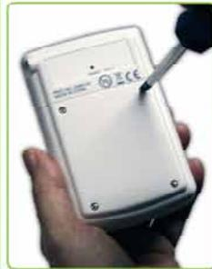
Usando un destornillador de cruz o plano, saque la tapa del compartimiento de pilas del Transmisor y ponga las pilas 3 AA. Pulse la tecla **RESET** situada en la parte posterior del Transmisor.
